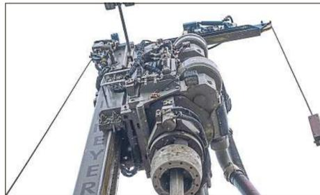
Der Antrieb für das Bohrgestänge hängt in luftiger Höhe und schiebt den Bohrer in die Tiefe.
