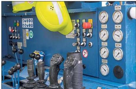
Bedienstand der Bohrmaschine: Von dort werden unter anderem die Drehzahl und der Vorschub für das Bohrgestänge eingestellt.
