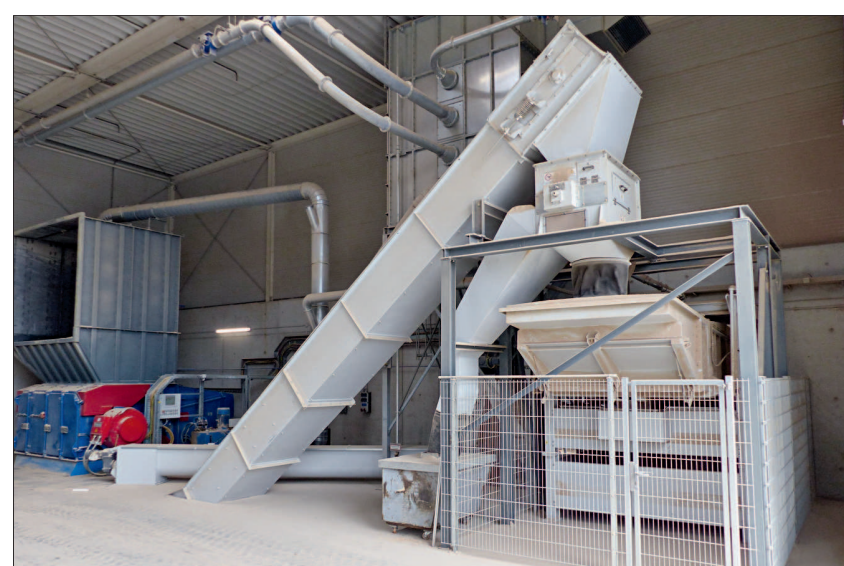
Holzaufbereitung mit Einwellen-Zerkleinerer von Vecoplan (links), Transportluft-System von Rippert und Siebanlage zur Trennung von zwei Fraktionen.
