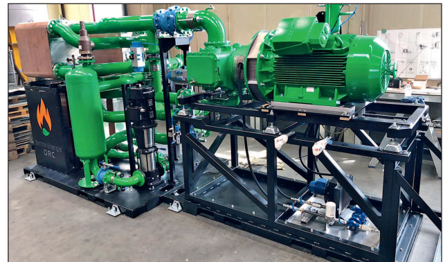
Die zwei verbauten ORC-Nachverstromungsanlagen sind eine Eigenentwicklung von Senne Energie.
